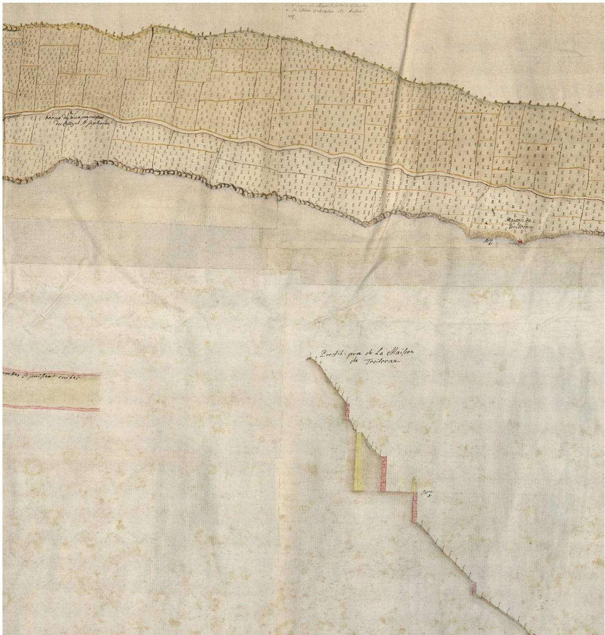
Fig. 10 – Plan du chemin par le Dézaley, par Hans Jacob de Diesbach, 1711. Détail avec profil vers la maison de Treytorrens. En jaune, les murs à construire ; en rouge, les murs existants à démolir.
