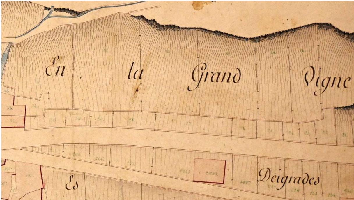
*Fig. 27 – Plan cadastral de Saint-Saphorin, 1828-1830, détail du secteur à l’est du village. Le dessin distingue nettement les murs de parapet ou de soutènement (trait double) des limites de propriétés (trait simple).
